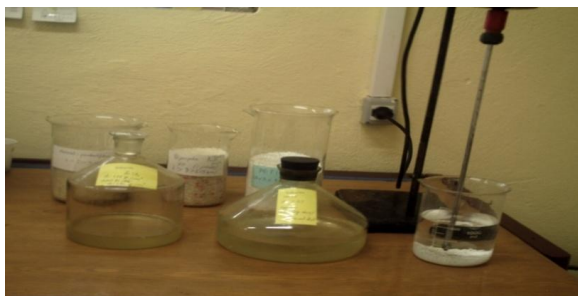
Fig.2. Identifikimi i materialeve plastike me anën e testit të densitetit (me flotim)
