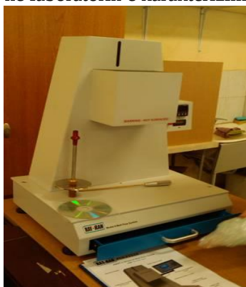
Fig. 9. Aparati MFI dhe përcaktimi i shpejtësisë së rrjedhjes së propilenit me anë të tij.
