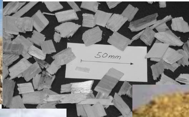
Copat e drurit të përdorura si lëndë djegëse për sistemin laboratorik të reaktorëve .
